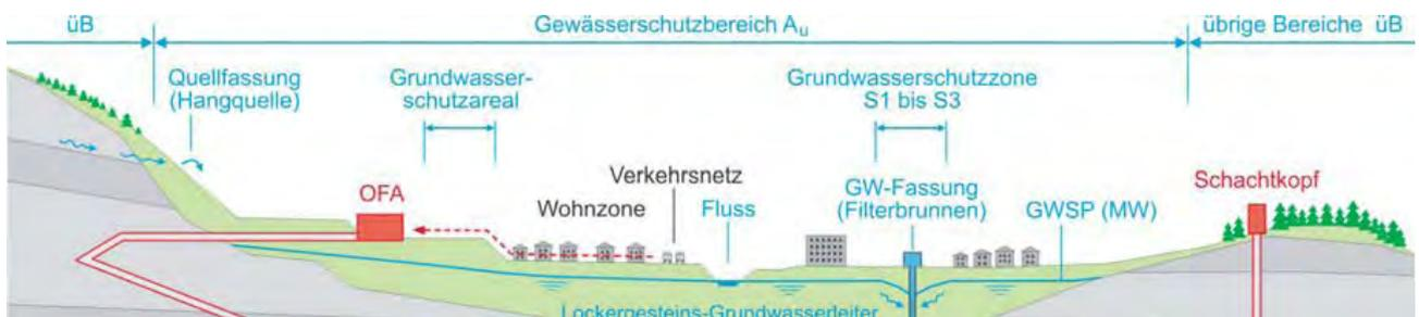
Konzeptbild (Auszug) für Lockergesteinsgrundwasser (gezeigt an der Aussprache vom 24.02.12). OFA: mögliches Standortareal einer Oberflächenanlage. Nagra 2012
